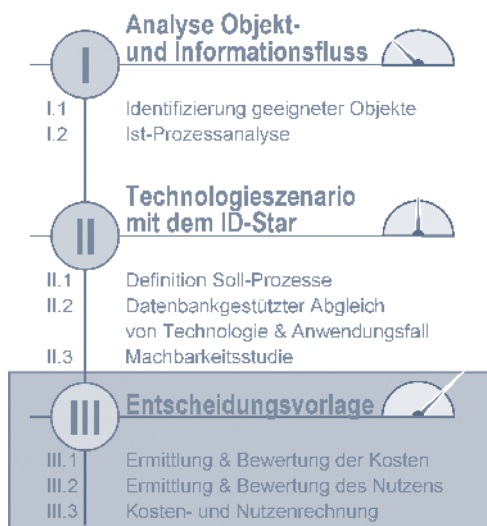
Bild 1 3-stufiges Vorgehen zur Planung und Bewertung von Auto-ID-Systemen (Fokus: Stufe 3) (in Anlehnung an [1])
