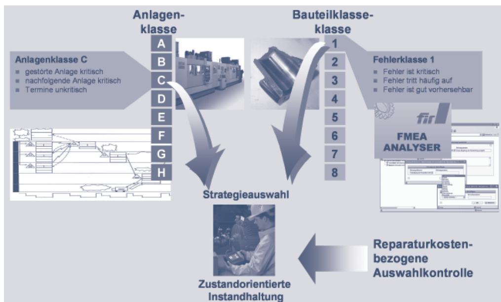
Bild 2 Beispiel zur Ableitung der optimalen Instandhaltungsstrategie
