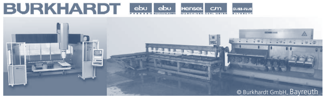
Bild 2 CNC gesteuerte Bearbeitungszentren mit 3 bis 5 Achsen und Kantenschleifautomat in fahrbarer Ausführung
