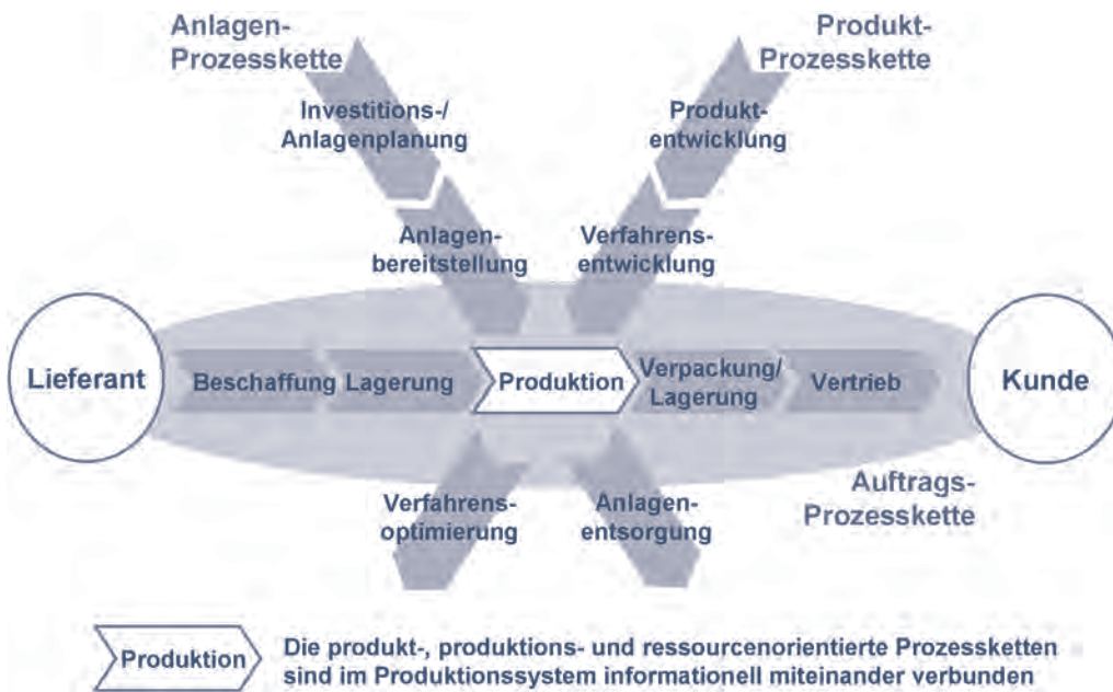
Bild 2 Schematische Darstellung eines Produktionssystems
