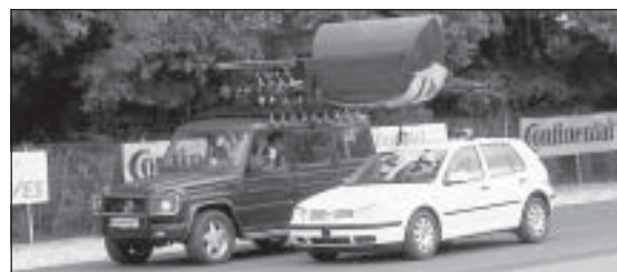
Bild 2: Der Dummy schwenkt in einer Auffahr-Situation nach oben, so dass das Folgefahrzeug ohne Beschädigung unter dem Dummy hindurchfahren kann.
