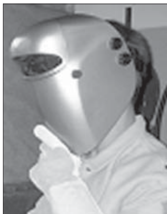
Bild 1: Die neuartige Schweißmaske - ausgestattet mit Kameras, Display und Computertechnik - ermöglicht eine bessere Sicht auf das Werkstück und gibt dem Schweißer zusätzliche Informationen über den Arbeitsprozess.
