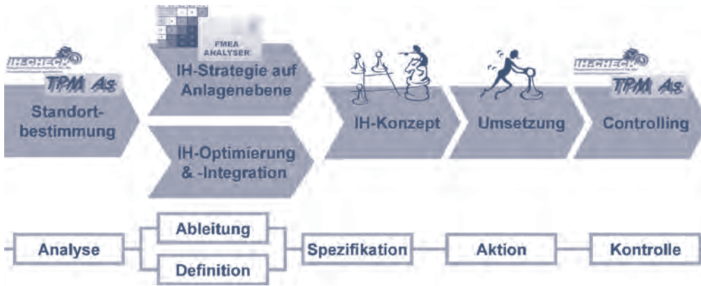
Bild 2 Strukturierte Vorgehensweise bei Instandhaltungsprojekten (Beispielprojekt für eine Instandhaltungsstrategieauswahl)
