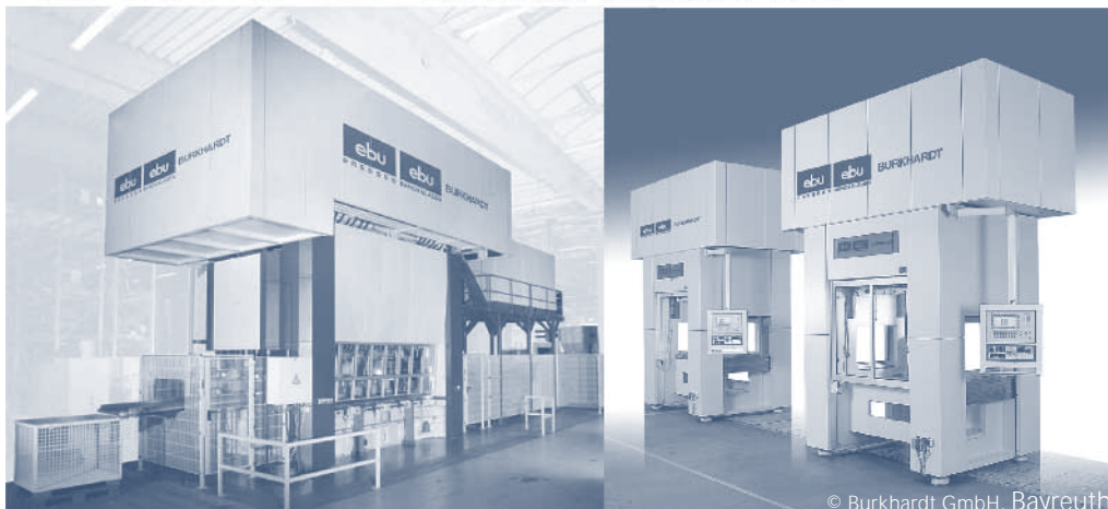
Bild 1 Der Stanzautomat (STA) ist prädestiniert für Stanz-, Biege-, Präge- und Umformarbeiten
